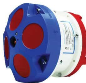
Profilatore della corrente lungo la colonna d'acqua (ADCP)
